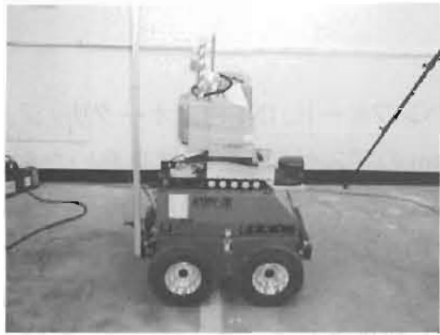
図1 INEELで使われたγ線測定装置
